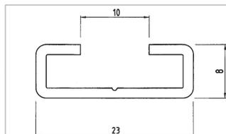
**AN 23 Zählerbefestigungsprofil**
